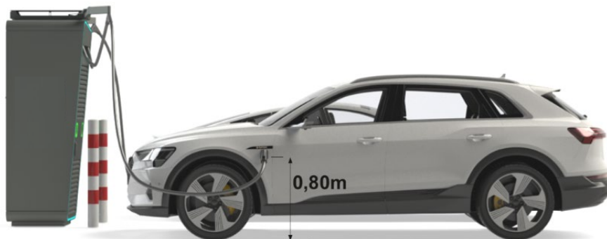
Abbildung 15: Standardladehöhe von 0,8 m
