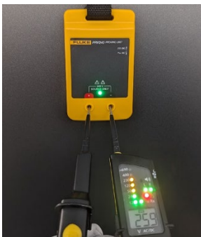
Abbildung 56: Validierung des Spannungsprüfgeräts
