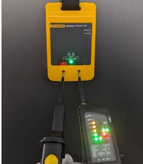
Abbildung 67: Validierung des Spannungsprüfgeräts
